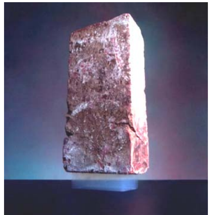
Σχήμα 3: Ένα aerogel με μάζα 2 gr στηρίζει ένα τούβλο με μάζα 2.5 kg.
