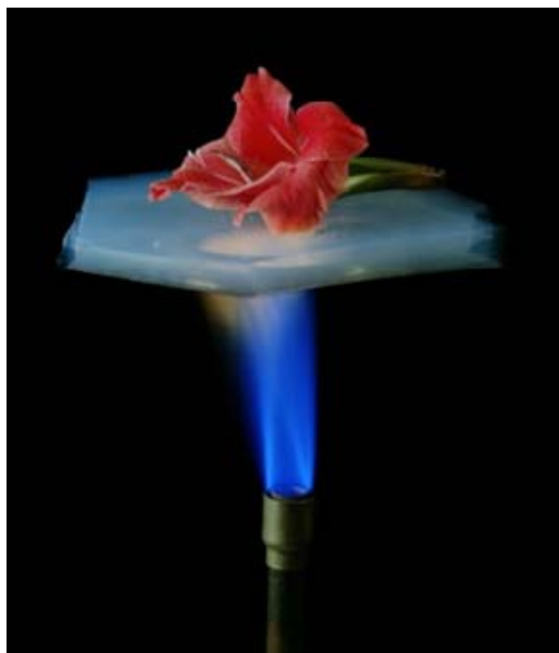
Σχήμα 4: Ένα λουλούδι στηρίζεται πάνω σε aerogel πάνω από ένα λύχνο Bunsen. Το aerogel έχει εξαιρετικές μονωτικές ιδιότητες και έτσι το λουλούδι προστατεύεται από τη φλόγα.
